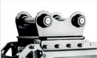
Адаптационная крепежная плита с проушинами под пальцы
